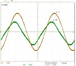
Für den zuverlässigen Betrieb ist es von größter Bedeutung, dass der Umrichter für den Sinusfilterbetrieb geeignet ist. Der Umrichter muss mit einer festen Taktfrequenz oder einem Band von Taktfrequenzen in der Größenordnung der Nennschaltfrequenz der Gleichtaktfilter von 8 bis 16 kHz arbeiten. Viele Umrichter arbeiten im Bereich niedriger Drehzahlen mit verringerter Taktfrequenz oder mit Pulsmustern ohne feste Taktfrequenz. Diese Betriebsarten sind mit dieser Filterlösung nicht zulässig.
